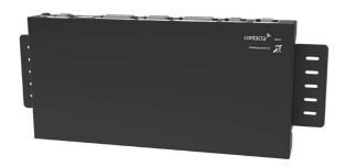
Der robuste 2-Kanal-Induktionsschleifenverstärker VLD1 verbessert die Kommunikation in Transportfahrzeugen wie Bussen und Reisebussen.
